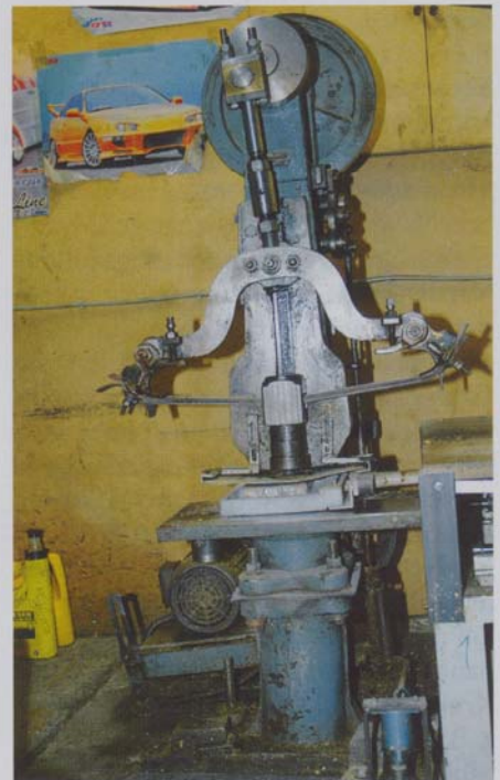
Der erste Schlagvorgang erfolgt mechanisch
