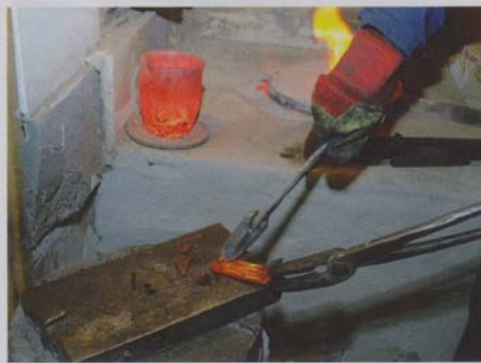
Der frisch gegossene Barren („Zain“) wird geschmiedet ...
